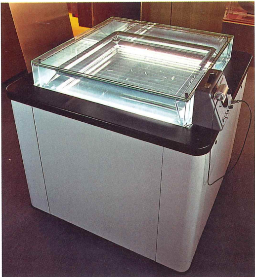
Cloud Chamber / 47 x 47" / Forschungszentrum Karlsruhe GmbH
